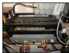
6080 3パラ OTL アンプ
