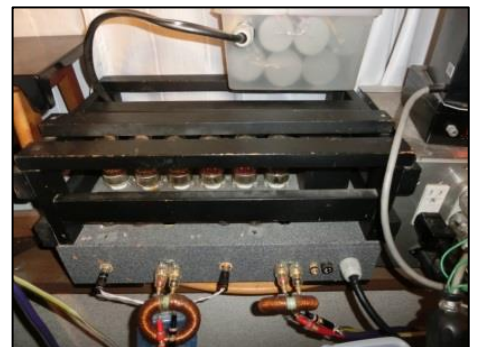
6080 3パラ OTL アンプ 神戸時代の2パラから3パラに改良 平滑コンデンサーはフィルムコン使用 コストダウンの為、木製シャーシ使用
